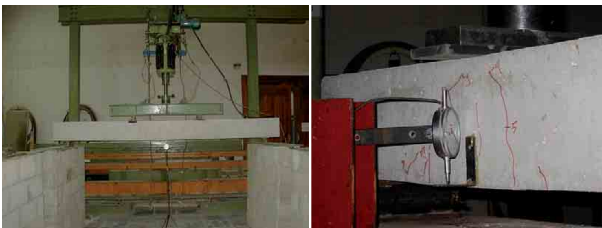
Figura 5. Dispositivo de ensayos a flexión en vigas.
