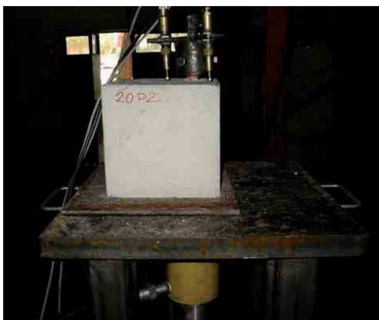
Figura 3. Probetas y dispositivo del ensayo pull - out.
