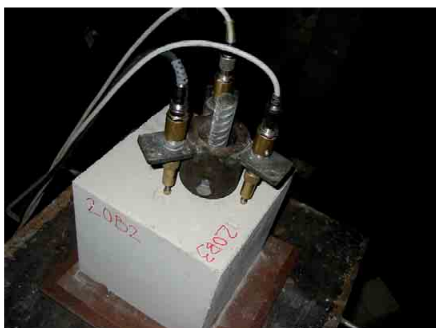
Figura 3. Probetas y dispositivo del ensayo pull - out.
