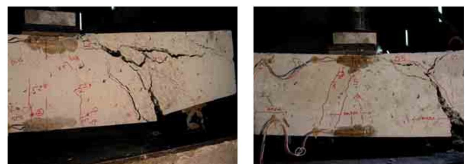
Figura 12. Fallos en vigas de pequeña esbeltez CA3 y CB3 (serie III).
